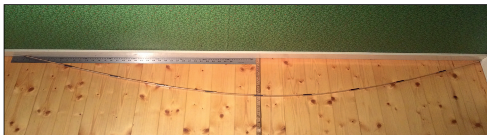
Figur 7: Experiment för att studera inverkan av vänstra ändens förskjutning på mittpunktsutböjningen för en tumstock.
