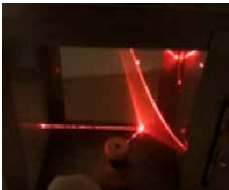
Figur 6: Ved å endre vinkelen mellom stråle og nål får vi en lyskjegle med annen åpning. Her er kjeglen rettet mot høyre med en vinkel A på nesten 90^\circ .
