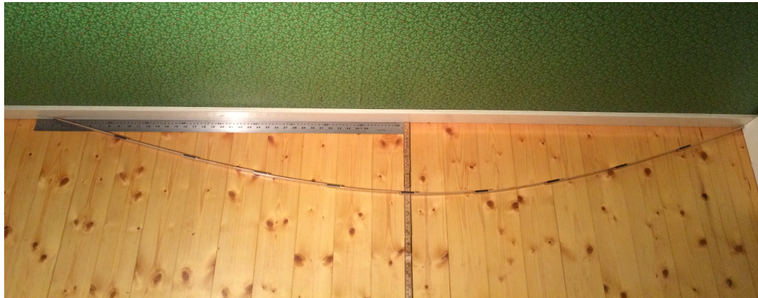
Figur 2: Experiment för att studera inverkan av vänstra ändens förskjutning på mittpunktsutböjningen för en tumstock.
