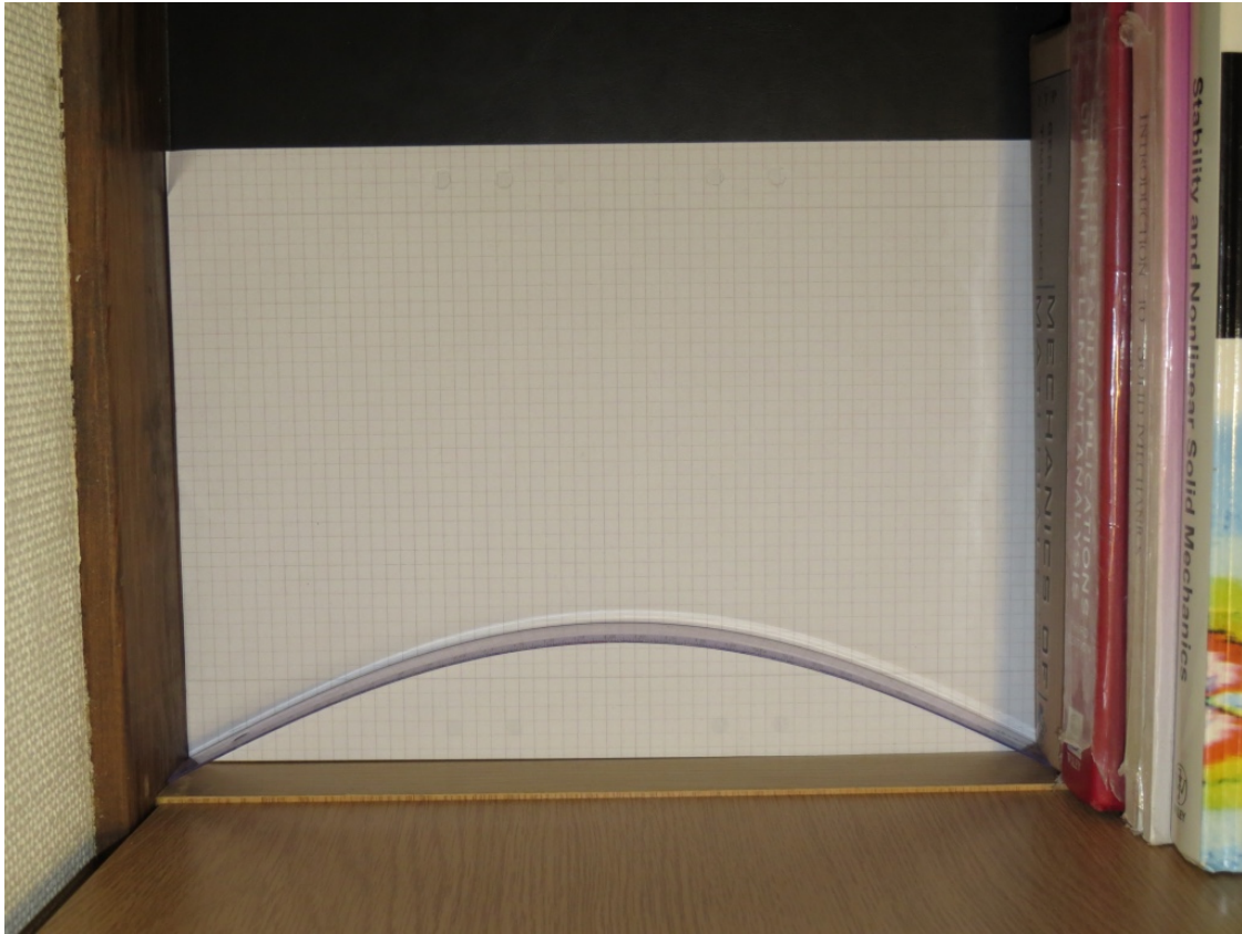
Figur 3: Experiment för att studera kurvformen för en plastlinjal. Linjalen böjs mellan en vägg och en hög med stabila och hållfasta böcker.
