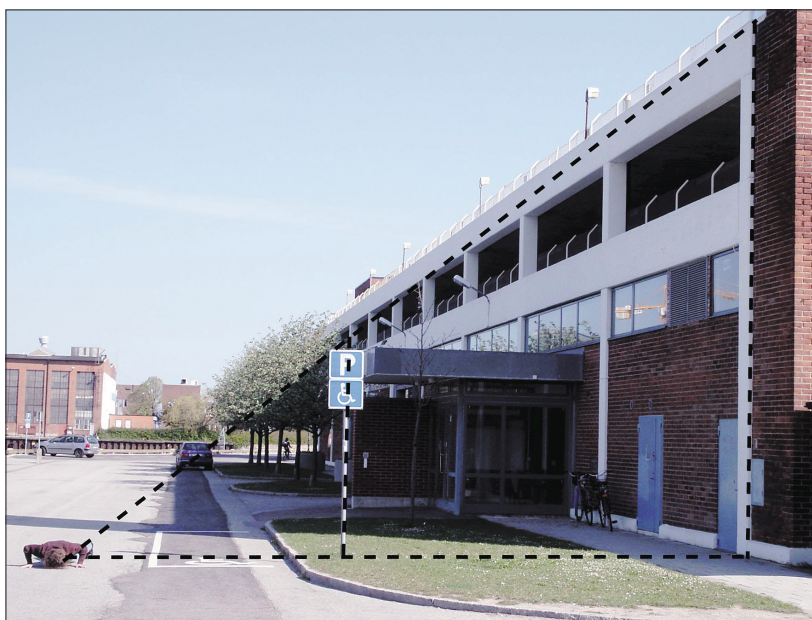
Figur 2. Syftning mot ett referensföremål ger upphov till två likformiga trianglar med vars hjälp man kan bestämma höjden av byggnaden. Bilden eleverna tagit under arbetet är viktiga för att knyta det de gjort till den mera abstrakta formuleringen i matematikboken.
